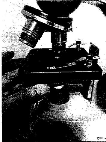
11. Para levantar el cabezal o ajustar la distancia de la muestra a los objetivos utiliza las perillas, macrométrica (negra) para ajustes grandes, micrométrica(azul) para ajustes pequeños.
